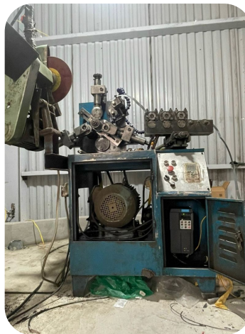
Biến tần MD290 cho máy Cán Tôn Cuộn
