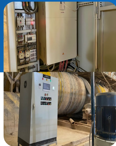
GK620 250kW/280kW và màn hình HMI Flexem cho Máy Nghiền Thô
