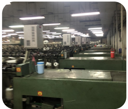
Hàng loạt Biến tần GK620 30kW cho dây chuyền Dệt Sợi
